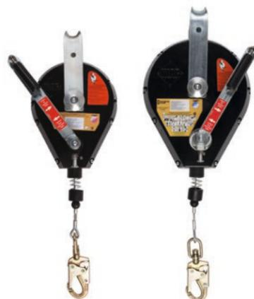
Anticaídas autorretráctil con mecanismo de rescate/recuperación bidireccional. Anticaídas con dispositivo de elevación y bajada de rescate, equipado con un mecanismo de recuperación accionado por una manivela montada en el dispositivo. Tras detener una caída, o si el usuario queda incapacitado en la parte inferior de un eje, un segundo puede accionar el mecanismo de recuperación fácilmente para elevar o bajar a la persona a un lugar seguro.
