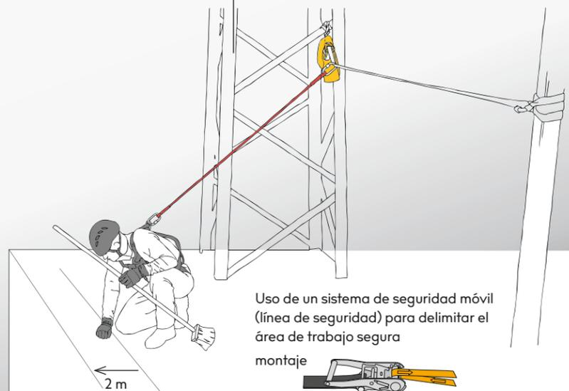
Uso de un sistema de seguridad móvil (línea de seguridad) para delimitar el área de trabajo segura montaje
