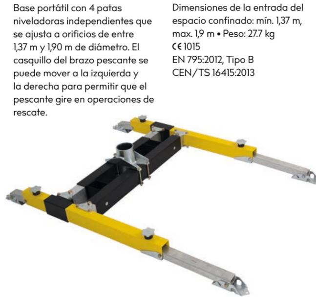
Base portátil con 4 patas niveladoras independientes que se ajusta a orificios de entre 1,37 m y 1,90 m de diámetro. El casquillo del brazo pescante se puede mover a la izquierda y la derecha para permitir que el pescante gire en operaciones de rescate.
