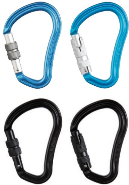
**Mosquetón HMS de gran versatilidad en forma de pera con gatillo de rosca/triple cierre diseñado para múltiples usos, principalmente para aseguramiento o anclaje en trabajos en altura. Por su alta resistencia y gran apertura del gatillo, se utiliza principalmente como mosquetón central en el anclaje.**
