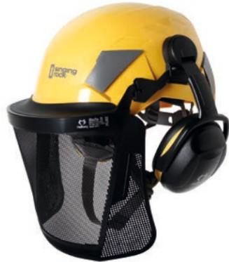
**Casco de protección indicado para trabajos industriales y obras de construcción. Su finalidad principal es proteger al usuario de la caída de objetos y del riesgo eléctrico. Tiene un barboquejo de seguridad que se desengancha con una carga de entre 15 y 25 daN, lo que elimina el riesgo de estrangulamiento.**
